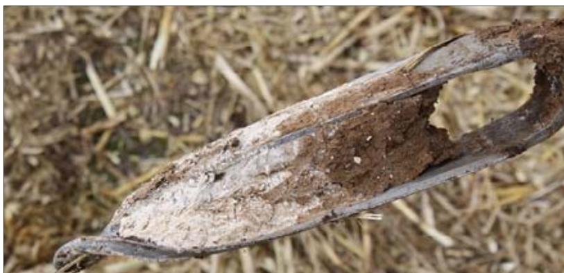
Figur 1. Boreprøve med grænsen mellem moræneler og kalk i 2,2 meters dybde under en mark nord for Thisted.
